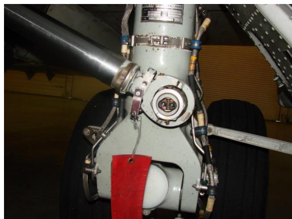
Рис. 12.2. Установка страховочных пинов (штырей), основные стойки шасси.
