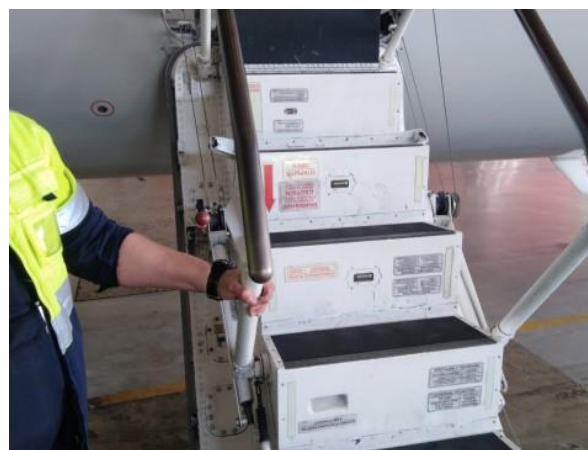
Рис. 3.2. Открытие пассажирской двери с вытяжной рукояткой
