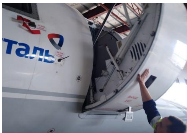
Рис. 3.2. Открытие пассажирской двери с вытяжной рукояткой
