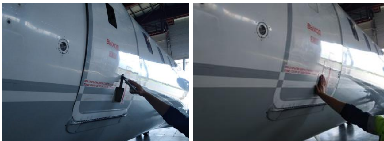
Рис. 3.3. Закрытие пассажирской двери с вытяжной рукояткой
